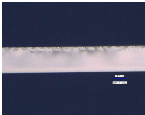
板厚 0.05 mm切断面拡大
