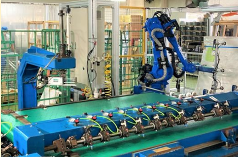
<原板自動投入ロボット&自動切断装置>
